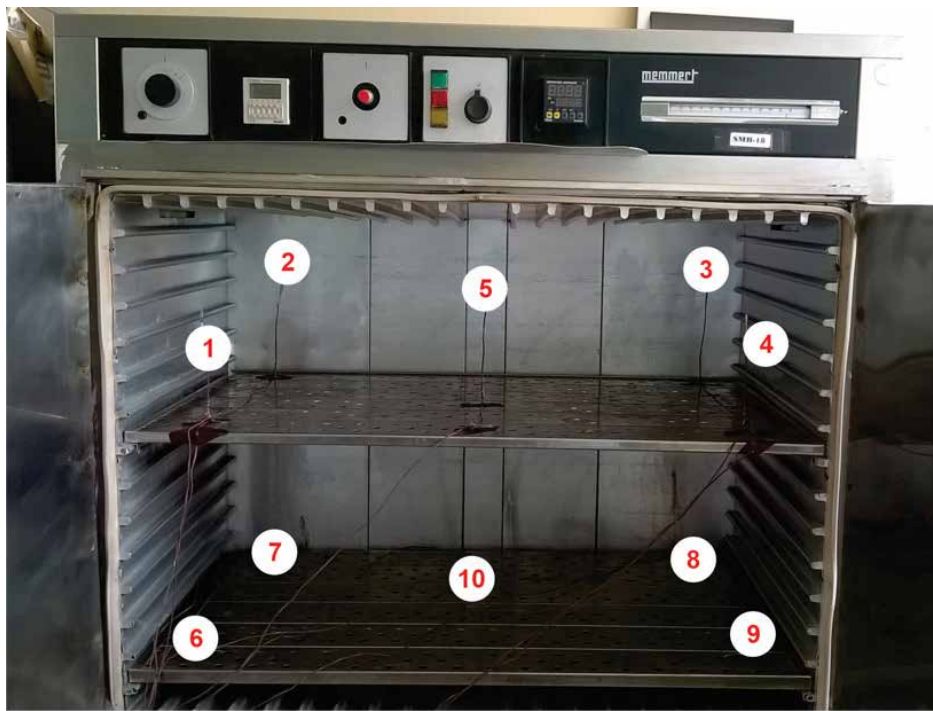
Figura 9. Ubicación de termopares en un horno de esterilización sin carga Fuente: Centro Nacional de Control de Calidad -Instituto Nacional de Salud
