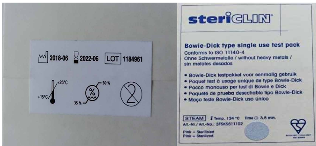
Figura 3. Foto frontal y posterior de un Test comercial de Bowie Dick Fuente: Centro Nacional de Control de Calidad -Instituto Nacional de Salud
