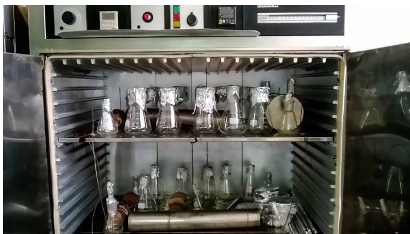
Figura 13. Ubicación de termopares en horno esterilizador con carga Fuente: Centro Nacional de Control de Calidad -Instituto Nacional de Salud
